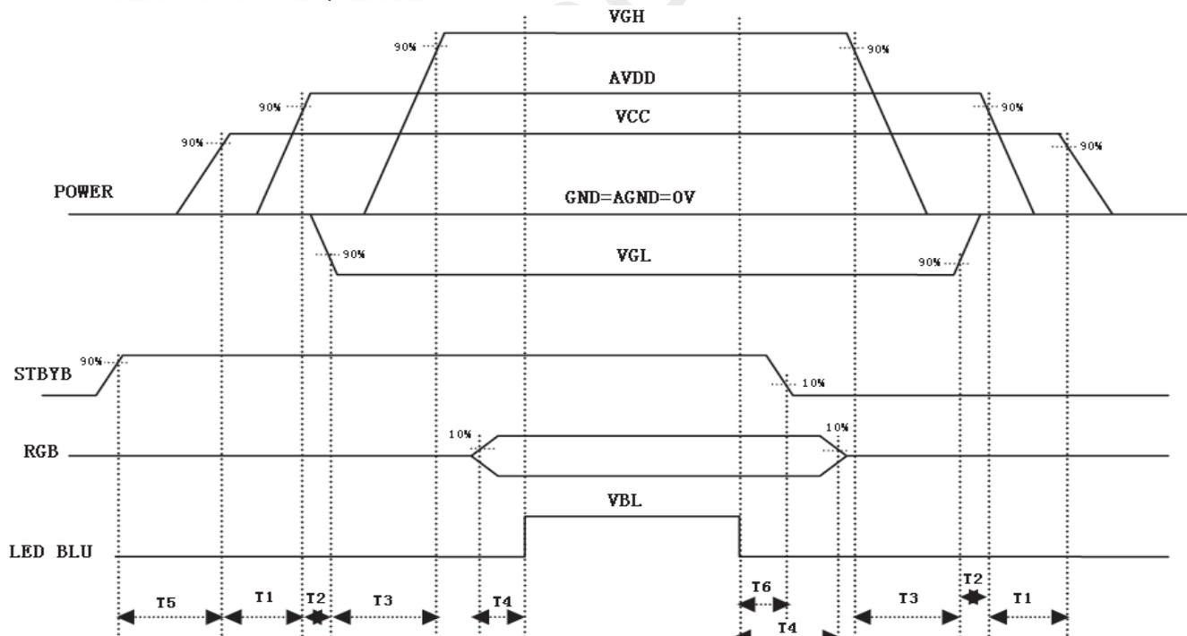
Note:  $T_1 \geq 20ms$ ,  $T_2 \geq 20ms$ ,  $T_3 \geq 5ms$ ,  $T_4 \geq 100ms$ ,  $T_5 \geq 5ms$ ,  $T_6 \geq 5ms$ .
